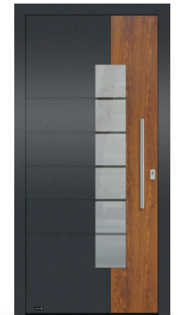
5007 Hier flügelüberdeckend mit Nuten und Stoßgriff 5825.1400 dargestellt. V: VSG mattiert mit klaren Streifen; Lichtes Glasmaß: 200 mm x 1400 mm O: Grundfarbe ca. DB 703 FSM A: Holzdekor Golden Oak U g : 1,0
