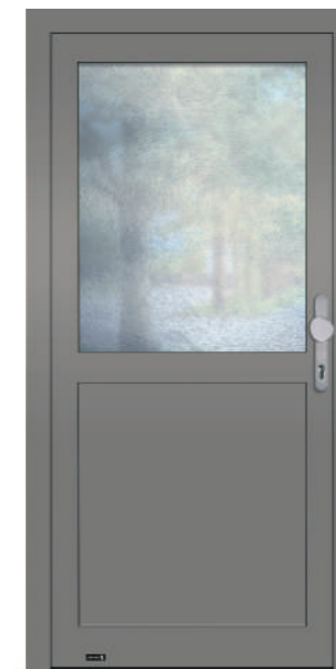
5506-2 Advance 75 Hier als Glasfalz-Füllung und Drücker 5706 dargestellt. Mit 100 mm Glasleistensprosse Unten wärmegeädämmtes Alu-Sandwich-Paneel, 30 mm stark.
